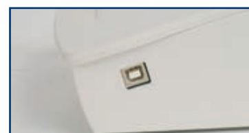
4 Conexión a PC que permite: - Actuaizar la TRS - 5000. - Visualizar código. - Almacenar código. - Modificar código. - Crear base de datos de clientes.
