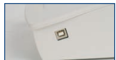
4 Verbindung zum PC: - Update des TRS-5000 - Lesen des Codes - Speichern des Codes - Änderung des Codes - Datenbankerstellung
