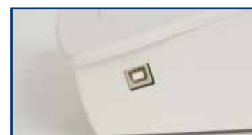
4 Podłączenie do komputera umożliwiające: - uaktualnianie TRS 5000 - czytanie kodów - przechowywanie kodów - modyfikacja kodów - tworzenie bazy danych
